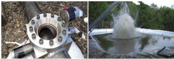
(a)試験後のガス噴出装置 (b)水中試験の様子 Fig.5 試験の様子
